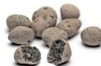
**Il Leca, principale costituente del blocco BioPLUS®, è la prima argilla prodotta in Italia.** È un prodotto naturale che deriva dalla cottura in forni rotanti di particolari argille. La temperatura di cottura, di quasi 1250° C, elimina completamente ogni tipo di sostanza organica dal prodotto.
