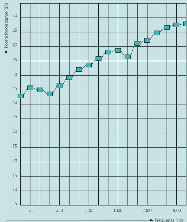
Indice di valutazione e termini di adattamento:  $R_w (C; C_{tr}) = 57 \text{ dB} (-1; -4) \text{ dB}$
