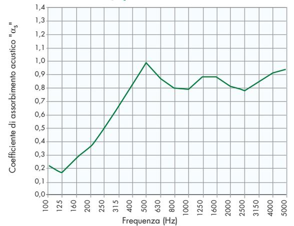
Grado di assorbimento secondo lo standard ISO 354, A2/A3, 7 dB (A) conforme a EN 1793.
