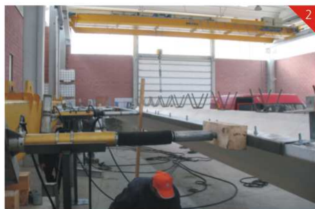
Collaudo dinamico per sisma orizzontale (moto oscillatorio)
