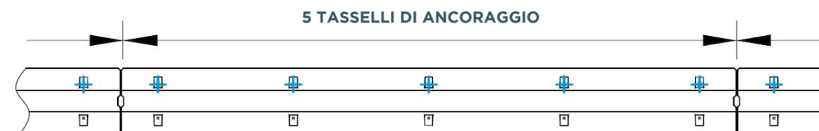
Se l'ancoraggio non è possibile a causa di un giunto di espansione sulla superficie di installazione, il punto di ancoraggio mancante deve essere compensato da 2 dispositivi di ancoraggio sul lato opposto della protezione di sicurezza, vedi figura. Questa procedura può essere applicata per analogia ad altre situazioni di installazione.
