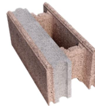
Il **Cappotto Sismico Paver** è un sistema per la riqualificazione sismica ed energetica degli edifici esistenti, composto da una famiglia di blocco cassero realizzati in calcestruzzo alleggerito Leca e con l'integrazione di uno strato di isolante Neopor.
