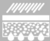
La Serie FILTRANTI è realizzata con impasto speciale a granulometria maggiorata. Tale miscela ne incrementa la capacità filtrante e favorisce il passaggio dell'acqua verso la falda acquifera senza l'utilizzo di ausili per la raccolta dell'acqua superficiale.
