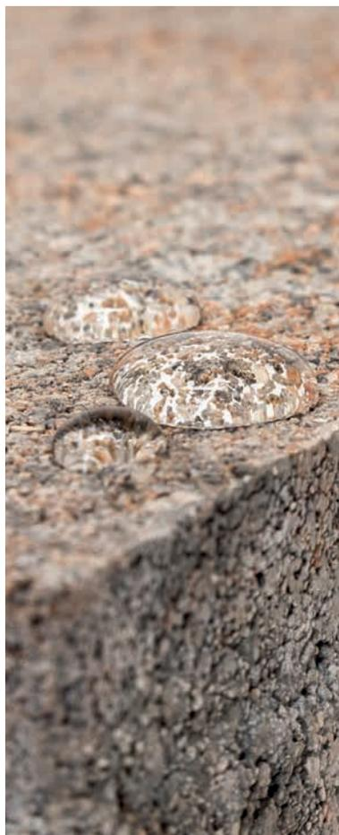
Paver Diamond Protection System® è un sistema additivante in emulsione di massa, che garantisce un potere idrorepellente forte e duraturo, grazie alla formazione di legami chimici in prossimità delle pareti dei pori; tale effetto inibisce la migrazione dell'acqua, che può contenere calcio idrossido ed altri sali, all'interno dei singoli elementi, limitando decisamente la formazione delle efflorescenze.
